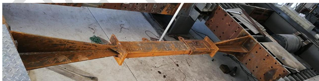
□ 双阶屈服屈曲约束支撑试验结果
